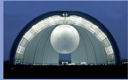
CL-75 im CargoLifter-Hangar, 60 m Durchmesser, 75 t Tragfähigkeit
