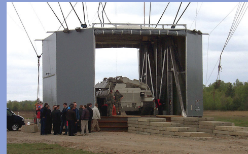
Test mit dem CL-75 Last: 55 t Minenräumpanzer Video unter 0113218
