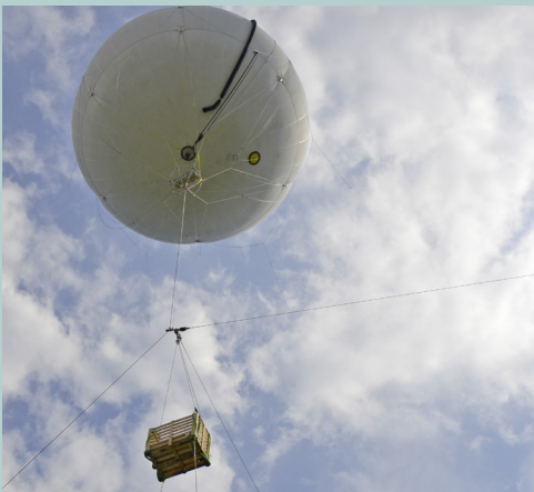
2012: Der 13,4m-Wasserstoffballon, der erste echte CargoLifter-Ballon seit 10 Jahren, hier als AirBridge in sogenannter Y-Konfiguration, unten: unser neues Mooringssystem „Spinne“
