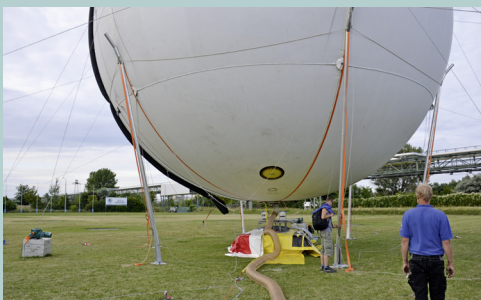
2012: Der 13,4m-Wasserstoffballon, der erste echte CargoLifter-Ballon seit 10 Jahren, hier als AirBridge in sogenannter Y-Konfiguration, unten: unser neues Mooringssystem „Spinne“
