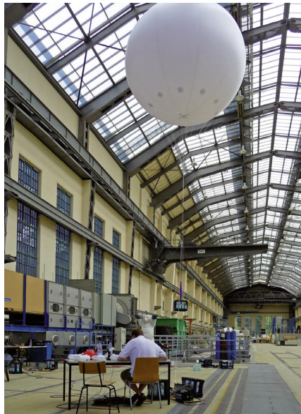
Das Testsystem mit 4-Meter-Ballon enthält alle für die Simulation nötigen Komponenten des großen Ballonkrans.
