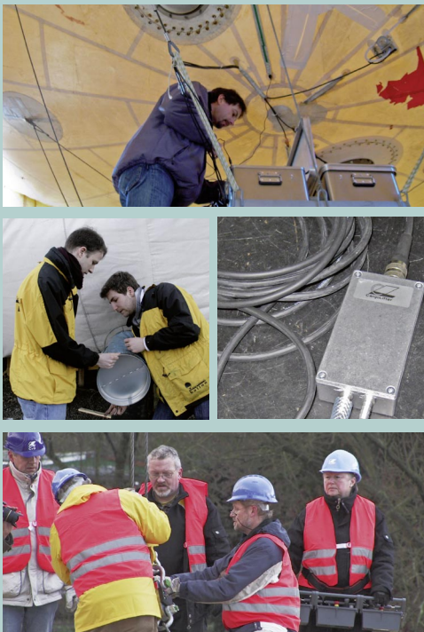
Oben: Während des Testbetriebs wurden viele Komponenten weiterentwickelt und Prototypen von Komponenten getestet (v.o.): Wartung der Mess- und Versorgungstechnik des Ballons; neu konstruiertes Ventil für den „Donut“; Drucksensor; Arbeiten am Kranknoten
