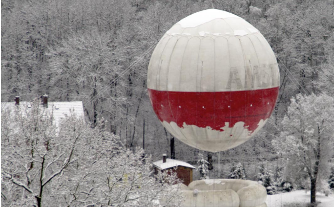
Gut zu erkennen: problematische Schneelast auf der Ballonkuppe
