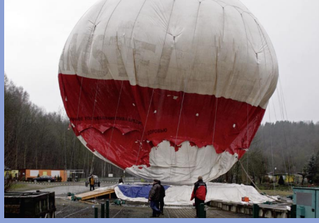
Je nach Füllstand werden weitere Teile der Ballontechnik montiert und angeschlossen.
