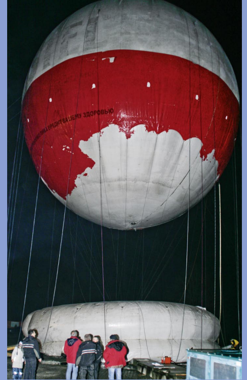
rechts: auch das Ballonett wird nun aufgeblasen, damit bekommt der Ballon seine pralle, runde Form, der Support-Ring unter dem Ballon ist erst halb voll
